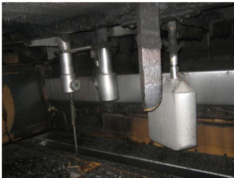
Rys. 2. Widok głowicy pomiarowej gęstościomierza radiometrycznego
